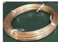
Leicht glänzende bis matte Oberfläche (Ziehen mit Pulverschmiermittel durch Hartmetall-Ziehstein)
