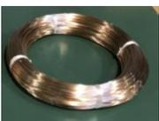
Glänzende Oberfläche (Ziehen mit flüssigem Schmiermittel mittels Diamant-Ziehstein)
